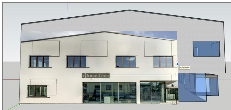
Abbildung 12.5: Vorgang der Texturierung aus terrestrischen Nahaufnahmen (eigene Darstellung)
