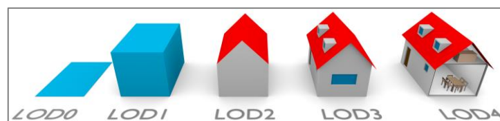
Abbildung 8.3: LoD-Stufen nach CityGML 2.0 (Biljecki et al., 2016, S. 2)
